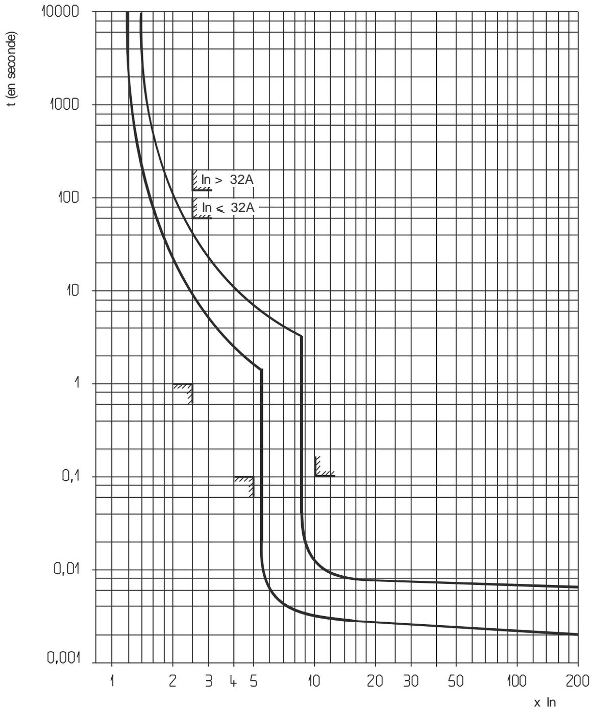
Déclenchement thermique temp. ambiant = 30°C
